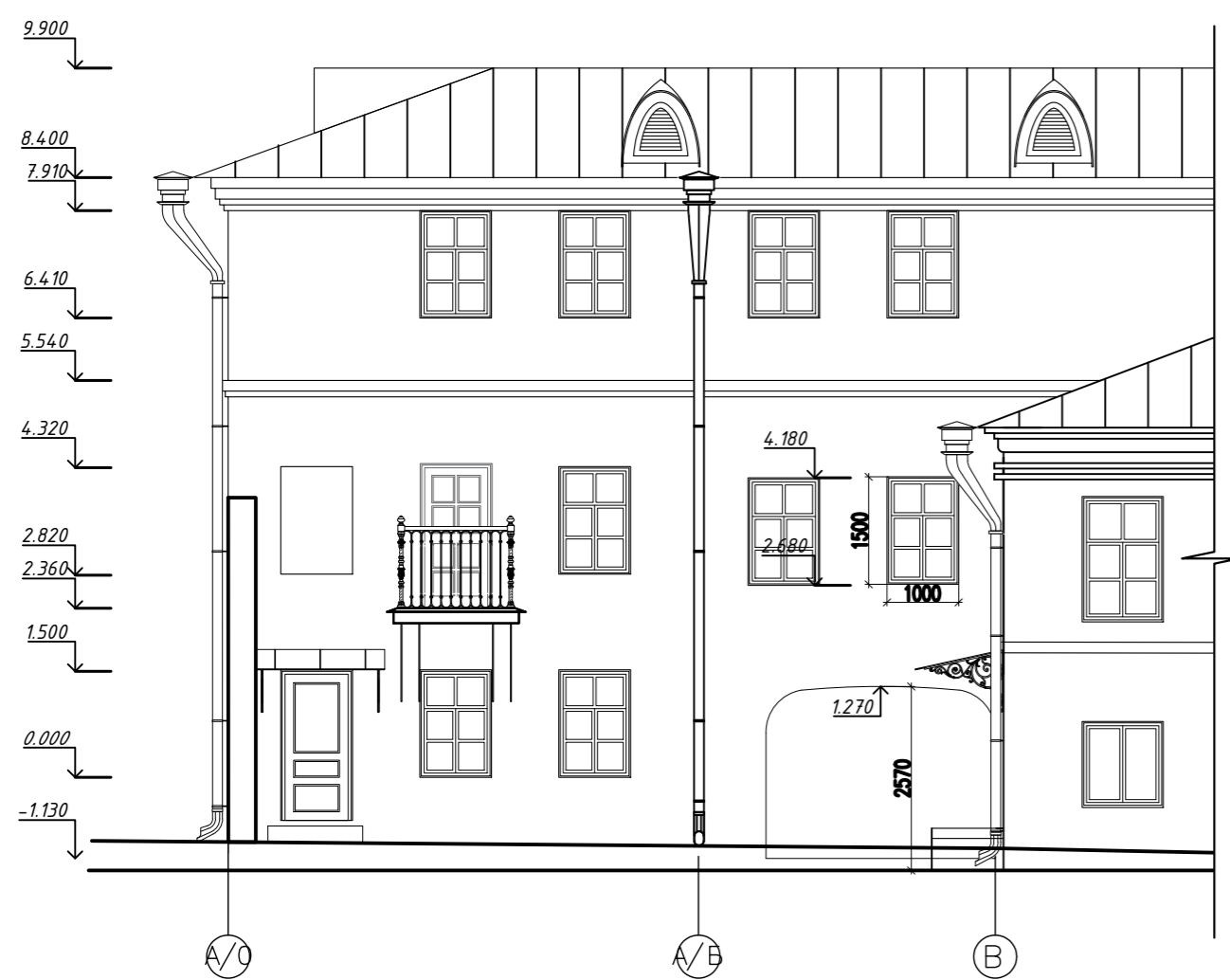
Фрагмент фасада в осях А0 - Н. М 1:100
